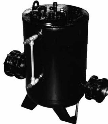
Der Armstrong-Kondensatheber der Serie EPT-400 für senkrechten Einbau ist eine wartungsarme mechanische Lösung zum Anheben von Kondensat oder anderen Flüssigkeiten von tiefer gelegenen Punkten, niedrigeren Drücken oder Vakuumräumen zu höher gelegenen Bereichen oder höheren Drücken. Kondensat kann bei Temperaturen weit über der 99°C-Grenze herkömmlicher elektrischer Kondensatheber rückgespeist werden, ohne dass Leckedichtungen oder Kavitationsprobleme auftreten.
